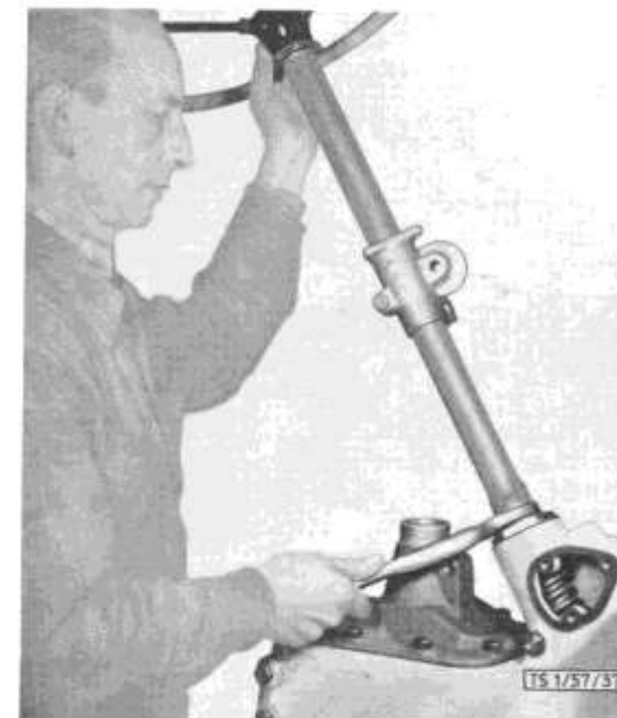
Bild 157: Festziehen des Lenksäulenrohres
