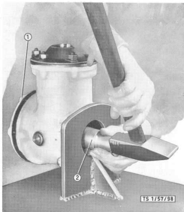
Bild 177: Austreiben des Tellerrades und Lagerdeckels
